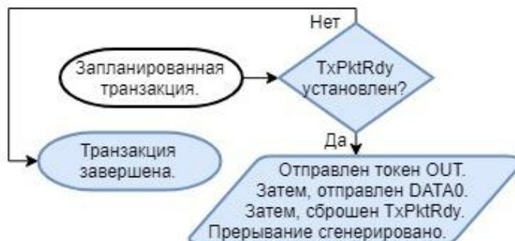
Рисунок 131 – Передача транзакций OUT
