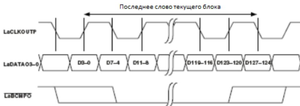
Рисунок 82 – Порт связи «а» передает порту связи «b» с завершением блока
