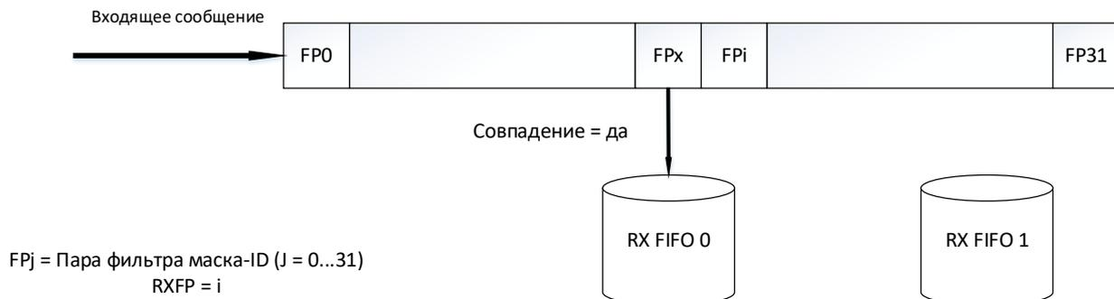
Рисунок 135 – нормальное функционирование RX FIFO 0
