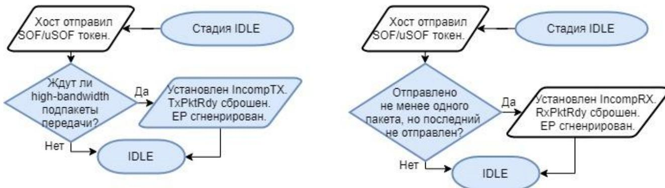
Рисунок 122 – Передача транзакций IN – слева, OUT –справа
