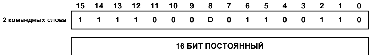
Рисунок 19–31 – Команда RPT с 16-разрядной непосредственной адресацией
