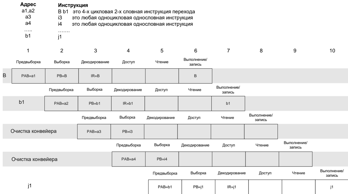
Рисунок 19–13 – Инструкция перехода в конвейере
