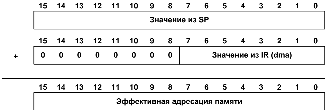
Рисунок 19–35 – Прямая адресация, связанная с SP
